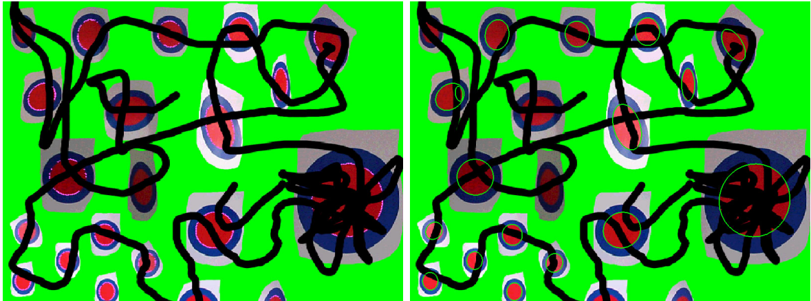
Abbildung 6.5. Konikanpassung bei teilweise verdeckten Landmarken. Als Testbild wurden mehrere Aufnahmen des gleichen Landmarkentyps in einem Bild zusammengestellt. Mit einem schwarzen Pinsel-Werkzeug wurde eine partielle Verdeckung der Marken simuliert. Links: Das Quellbild, bei dem die erkannten Punkte der Grenzkurve magentafarben markiert wurden. Rechts: Die Rekonstruktion der Grenzkurven durch die Konikanpassung. Anmerkung: Da die hier gezeigten Landmarkenbilder mit einer „klassischen“ Kamera aufgenommen wurden, sind die Grenzkurven tatsächlich Ellipsen. Das Bild wurde erzeugt, indem die Konikanpassung mit der Kalibrierung einer Lochkamera parametrisiert wurde. Ein Bild der Anpassung bei einem Panoramabild findet sich in Abbildung 6.4.
