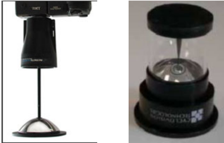
Abbildung 3.2. Zwei Panoramakameras unterschiedlicher Bauweise. Bei beiden befindet sich unten ein verspiegeltes Kreisparaboloid als Primärspiegel. Links: Eine Linsoptik schickt die parallelisierten Sehstrahlen einer handelsüblichen Einzelbildkamera, die von oben auf das Objektiv geschraubt wird, auf den Spiegel. Rechts: Bei diesem Modell befindet sich der lichtempfindliche CCD-Chip im Sockel. Ein konkaver Parabolspiegel, der dem Primärspiegel entgegengesetzt ist, fokussiert die parallel eintreffenden Lichtstrahlen auf ein Loch in dessen Scheitel. Darunter befindet sich ein standardisiertes Kameramodul, das das Bild aufnimmt.
